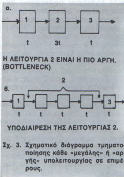
Σχ. 2. Σχηματικά διαγράμματα λειτουργίας της τμηματοποιημένης επεξεργασίας ενός διοχετευόμενου επεξεργαστή.
