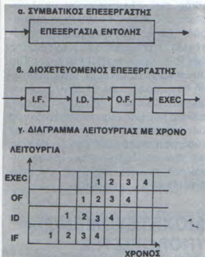
Σχ. 2. Σχηματικά διαγράμματα λειτουργίας της τμηματοποιημένης επεξεργασίας ενός διοχετευόμενου επεξεργαστή.
