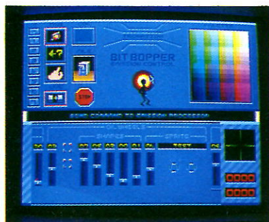
Una schermata del pannello di controllo dell'Archimedes che funge da Controllore di Emissione. Il software non è ancora completo, ma viene già gestito tramite un'interfaccia utente basata su slider simulati, di immediata comprensione per chiunque abbia pratica di mixer audio o video.
