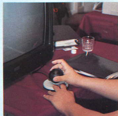
Si chiama Geoball e serve per controllare lo schermo di un mondo virtuale. La palla risponde a sollecitazioni sopra, sotto, a sinistra, avanti, indietro, in senso orario e antiorario consentendo un controllo in 8D - essenziale per manovre nello spazio tridimensionale.
