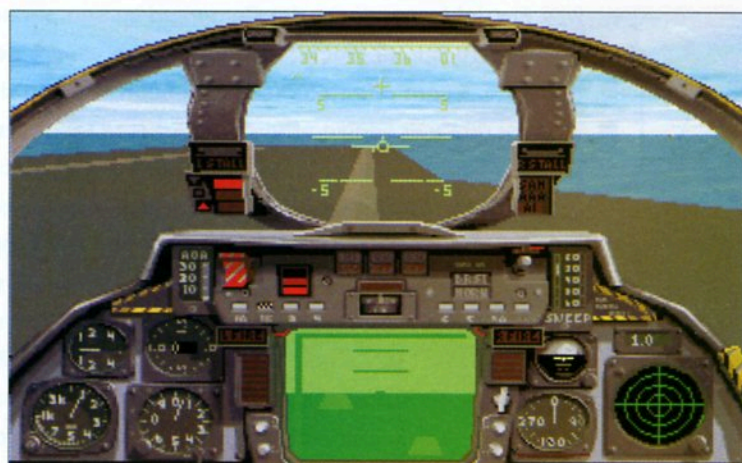
Il quadro comandi del pilota. Lo schermo al centro può anche proiettare le immagini raccolte dalla telecamera di bordo.
