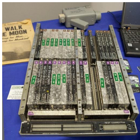
Figura 2: l'interno dell'AGC evidenzia la sua costruzione modulare e compatta.
