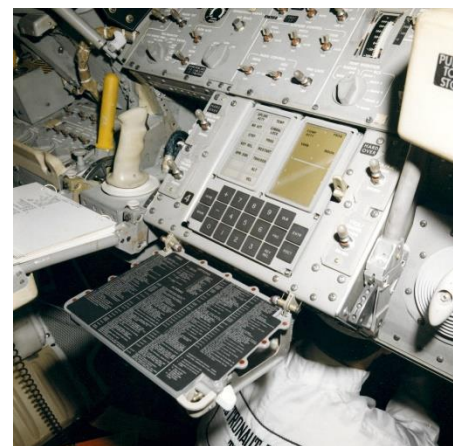
Figura 3: Il DSKY a bordo del LM Antares
