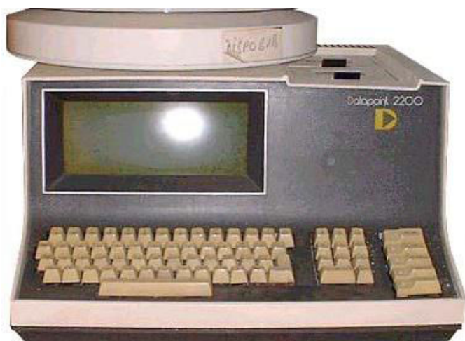
Figura 1: Datapoint 2200: la sua CPU era composta da 100 integrati della serie 7400 (foto: Wikimedia Commons)
