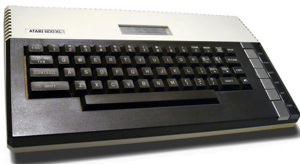
Figura 1: L'Atari 800XL montava i chip custom ANTIC, GTIA e POKEY per alleggerire la CPU dalla gestione di video e suono
