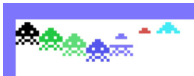
Figura 1 - il TMS9918 visualizza solo 4 sprite per linea di scansione
