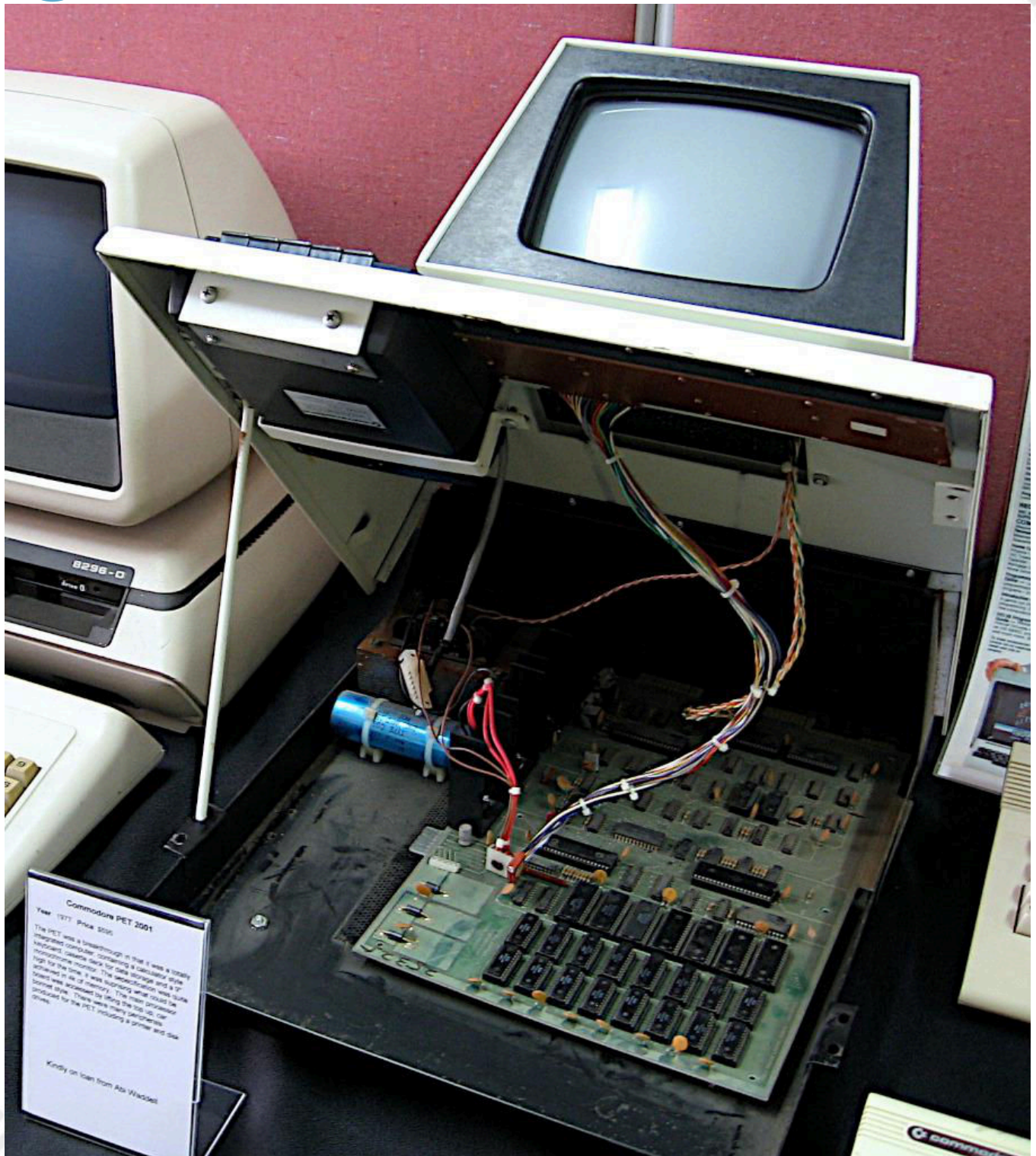
Fig. 4 - L'apertura a "cofano di auto" del PET (foto: Marcin Wichary – fonte: Wikimedia Commons)
