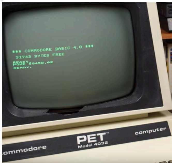
Fig. 7 - Gli effetti della "killer POKE", si vede la distorsione sull'immagine che viene compressa verso il centro (foto: André Fachat - fonte: 6502.org)
