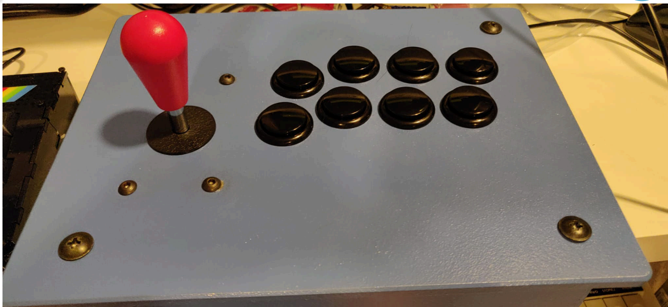
Fig. 12 - Joystick arcade USB con zero delay controller usato per testare la console
