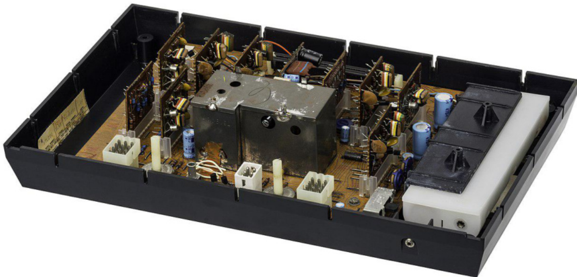
Fig. 4 - L'interno della Odyssey. Si vedono i circuiti realizzati con componenti discreti (foto: Evan-Amos)
