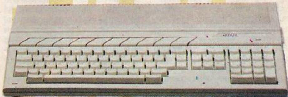
L'Atari aveva così fretta di lanciare il computer che nei modelli della prima serie era necessario caricare i 200 K del TOS da disco prima di poterlo usare. Le nuove serie hanno una versione 'ripulita' del TOS nella ROM.
