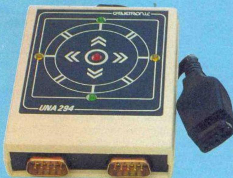
Universal joystick adapter - Indicatore luminoso di funzioni con 5 led - Possibilità d'ingresso con due prese SD-SUB D 9 poli in parallelo. **ART. UNA 294.**
