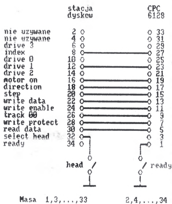
Rys. 1 — Połączenie między stacją dysków a komputerem Amstrad CPC 6128
