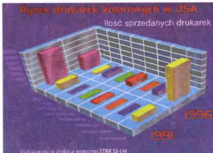
Rys 3. Przykład druku na folii. Uwagę zwracają cienkie linie pionowe - efekt kolejnych przejść głowicy
