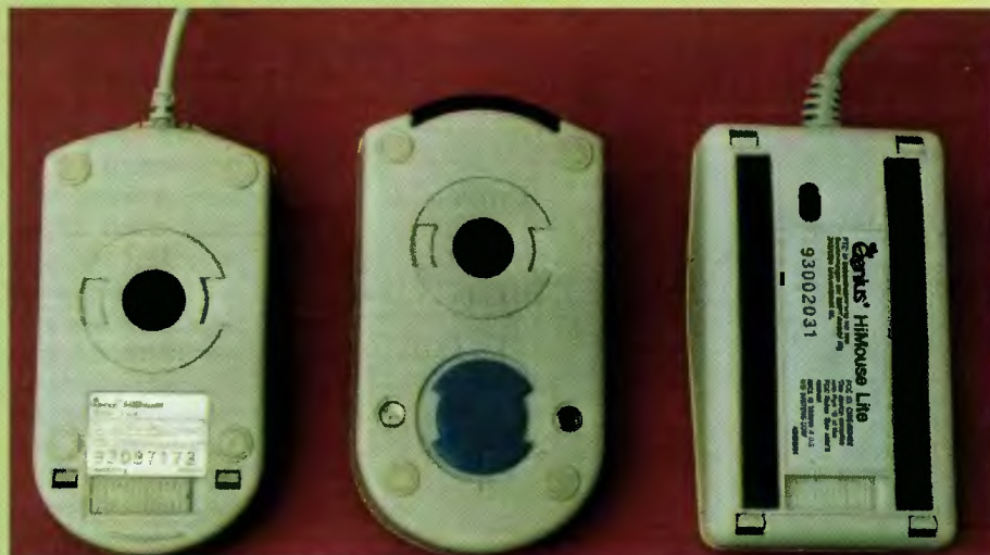
Typowa mysz mechaniczna. U dołu widoczny przełącznik między trybem pracy MS Mouse i PC Mouse.
