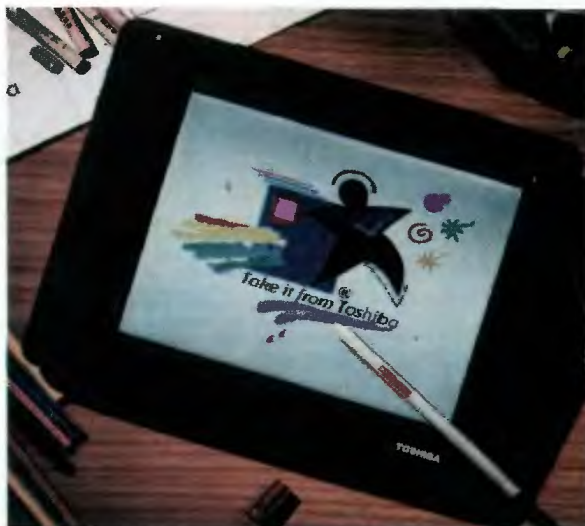
Toshiba Dynapad T200, przedstawiciel „rysykowców” (i486DX2 40 MHz, HD 80 MB, 4 MB RAM, 2xPCMCIA, ekran kolorowy)
