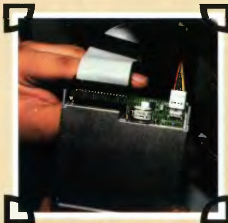
– Podłączanie kabli do stacji 3,5”. Po prawej widoczne złącze zasilania, inne niż dla pozostałych urządzeń.
