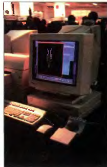
8. Stacja robocza Hewlett-Packard PA-RISC z trójwymiarową myszką.
