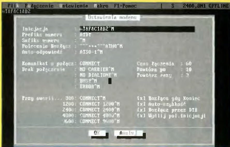
Konfiguracja portu szeregowego w terminalu TERM95.EXE.
