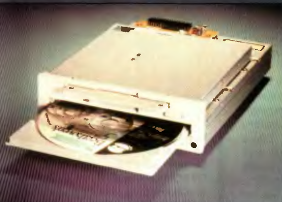
2. Połączenie stacji 3,5” z napędem CD-ROM: proste, małe i praktyczne
