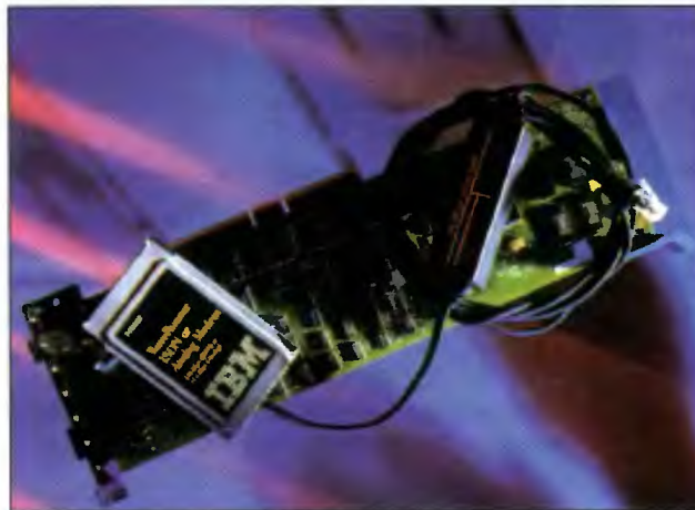
Modem analogowo-cyfrowy WaveRunner na karcie rozszerzenia i PCMCIA.
