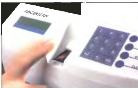
FingerScan – identyfikacja osób wykorzystująca trójwymiarowy wzorec palca.
