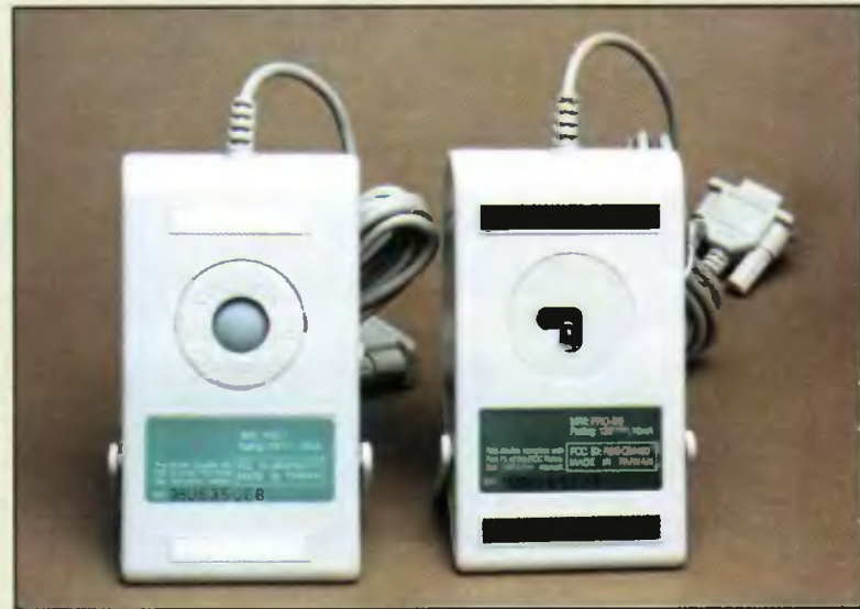
6. W myszy optomechanicznej ruchy ręki przenoszone są za pomocą kulki (po lewej). Myszy optyczna nie ma elementów mechanicznych.
