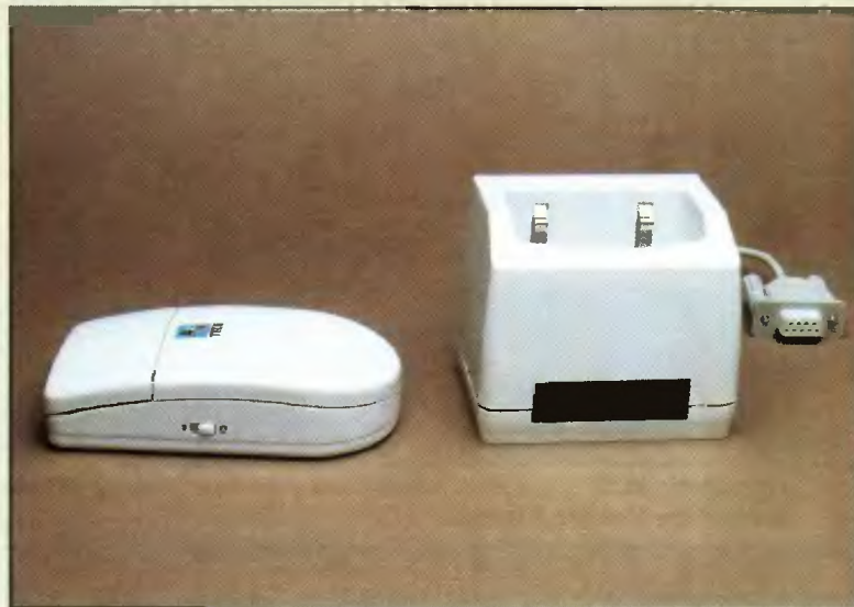
2. WinMouse Cordless przyczojona obok podstawki, będącej jednocześnie odbiornikiem i ładowarką.
