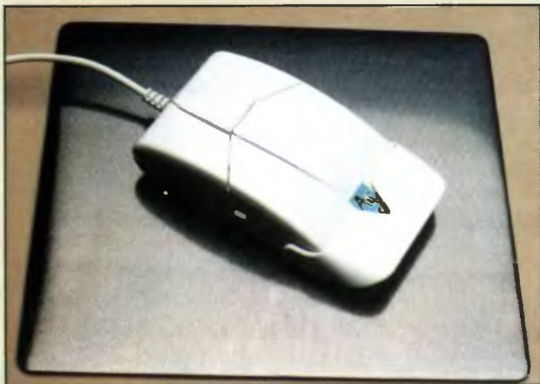
5. Optical WinMouse razem ze specjalną podkładką podzieloną na setki drobnutkich kratek. Myszy wyposażona jest w parę czułych oczu zliczających mijane kratki na podkładce.
