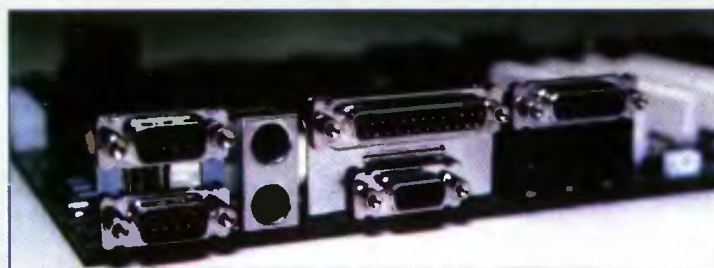
Rys. 2. Panel I/O. Na górze schemat ze specyfikacji Intel'a, na dole przykład panelu z płyty ATX ASUSa.
