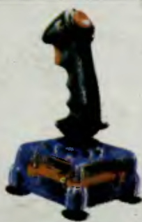
SV 127 Top Star 2 Fire 6 Mikrostyków AutoFire Przezroczysta obudowa SAS — Shock Absorbing System Platynowane części
