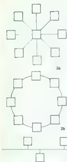
Prikazane su najpogostejše topologije mreži. Zvezdasto omrežje (slika 2 a) je značilno za vse zgodnejše tipe mrež, težko je npr. telefonsko omrežje. Zvezdasto omrežje pravi centralnega vozla, od katerega je tudi odvisna zanesljivost zveze. Obročni ali zanka (sl. 2b) so danedneje zelo pogosti pri konstruiranju posameznih mrež. Če posamezne vozle oddajo, lahko okvara povzroči prekinitev zveze med drugimi vozli. Sl. 2 c prikazuje tipično obliko zveze. Vse lahko poljubno dojedemo ali odvzamemo in to popolnoma brez vpliva na zveze med drugimi vozli. Težko obliko ima npr. Ethernet.
