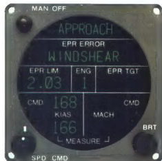
Instrument Sperryjevega računalnika, s katerim je mogoče odkrivati in meriti navzdolne sunkne vetra.
