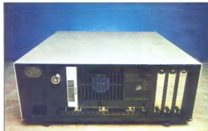
Vsa standardna vrata vodijo od matične plošče in reže so zdaj zato proste za nadalje razširitev. Z leve proti desni: priključki za tipkovnico, miš, dvomerni Centronics, RS 232C in video izhod. Ventilator, vdejan v sredini, je skoraj neslišen.
