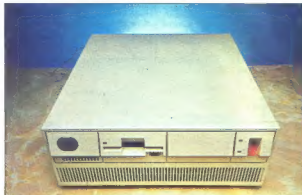
Za nove stroje IBM je značilno, da niso več tako »zvišani« kot prejšnji PC. To velja tudi za novi 3,5-palčni diskovni pogon, ki se mu obeta, da bo obetal. Glavno enako se je preselilo na sprednji del, ključavnica pa je zdaj zadaj.
