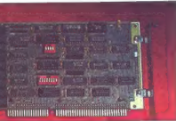
Pomnilniška kartica CSS TurboRAM, razvita za model IBM XT-286 in računalnik CSS 286-X.
