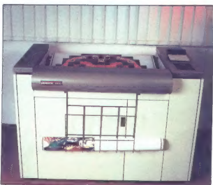
Versatec 8900: elektrostatični tiskalnik 3. generacije.
