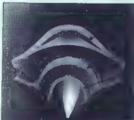
Modeliranje polja temperatur okoli trupa vesoljskega letala NASP s superračunalnikom cray Y-MP. Na sliki je prikazan pri hitrosti 30 machov. Barve konstrukcijskega povesja, da je temperatura 18-krat višja od atmosferske in zato bodo morali zasnovati metode za hlajenje trupa med poletom.
