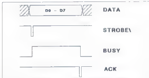
Slika 7. Časovni potek kontrolnih signalov pri paralelnem prenosu po centronicsu.
