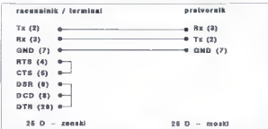
Slika 8. Shema povezovalnega kabla za protokol XON/XOFF.
