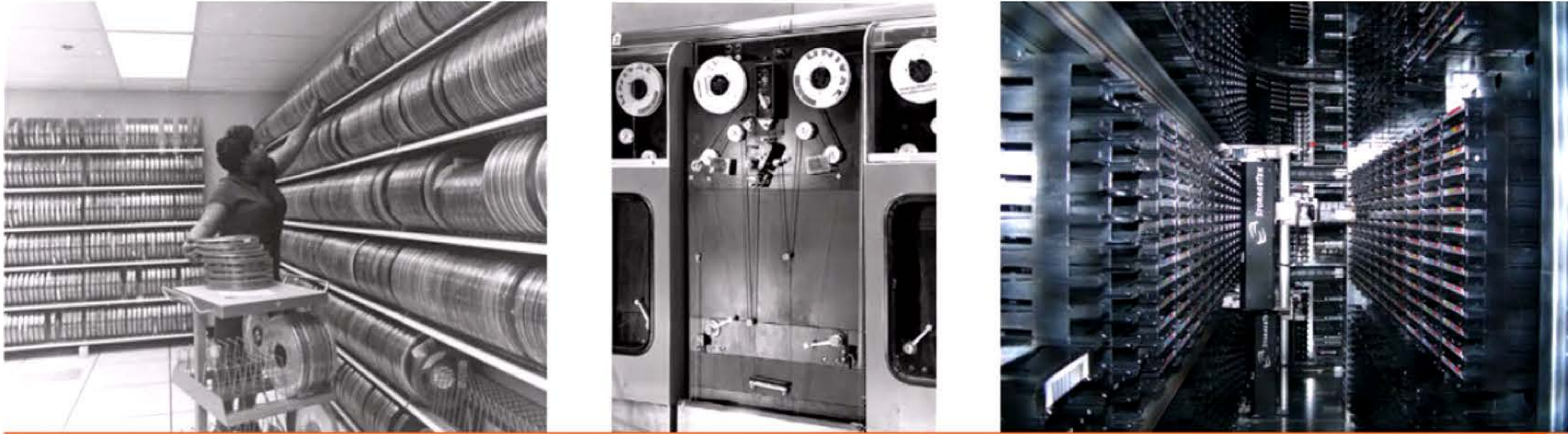
De gauche à droite : Bibliothèque de bandes magnétiques dans les années 1960. Bandes magnétiques de stockage permanent sur l'Univac 1. Intérieur d'une bibliothèque de sauvegarde à cartouches actuelle.
