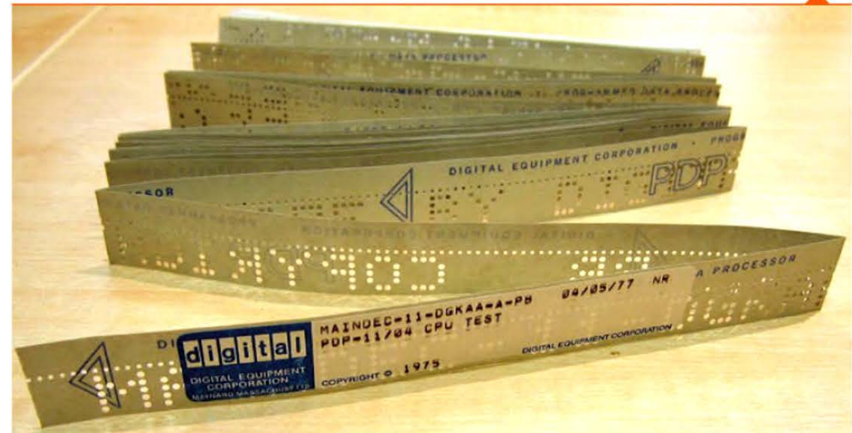
Bande perforée portant des programmes de test du processeur d'un PDP-11 en 1975.
