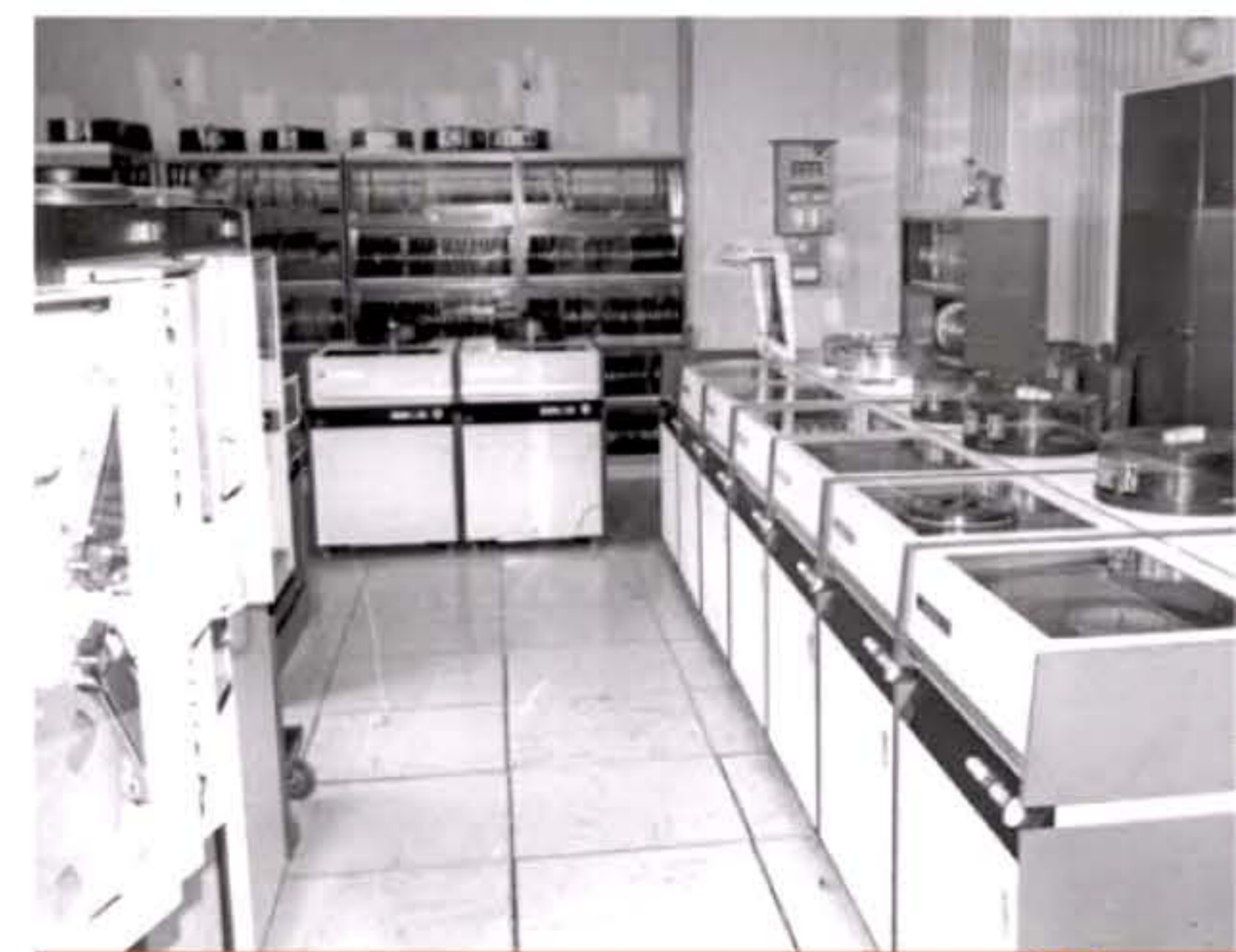
Disques magnétiques du centre de calcul CII à l'université de Lyon (1975).
