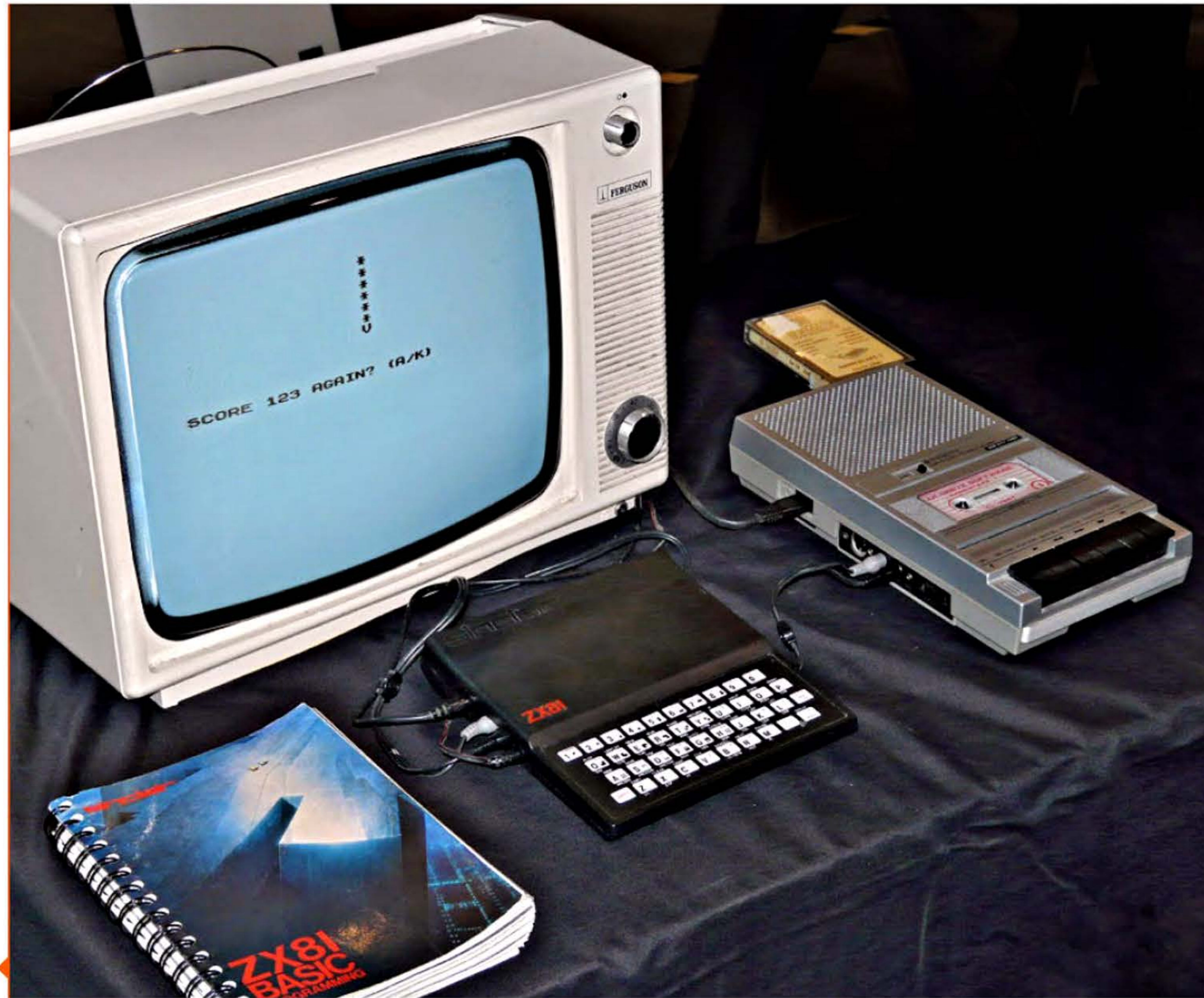
Installation classique d'un ZX-81 avec le lecteur de cassette faisant office de mémoire de stockage.
