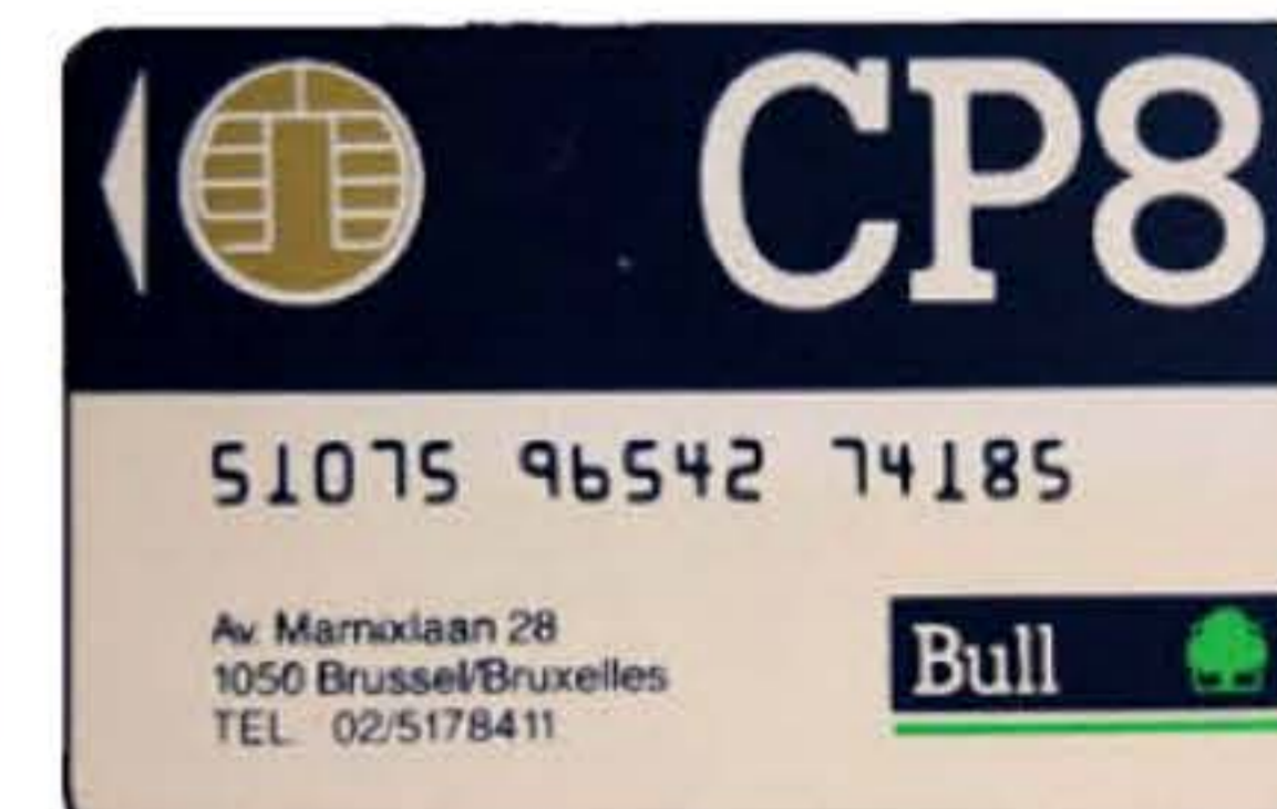
Carte à microprocesseur Bull de Michel Ugon, développée en 1977. Elle combine trois technologies : puce, caractères OCR, et piste magnétique au verso.
