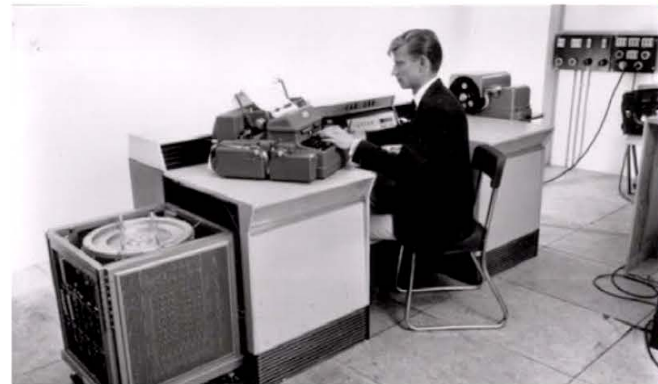
▶ CAB 500 de la SEA (le tambour magnétique est sorti de son meuble pour la démonstration).
