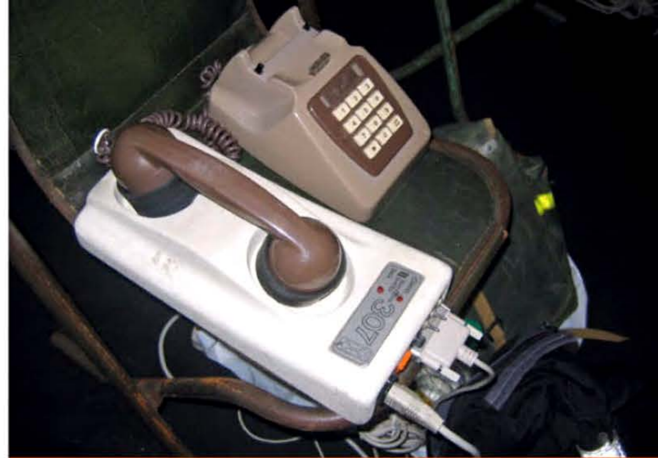
Modem acoustique (boîte blanche) « dialoguant » avec le combiné téléphonique via un haut-parleur et un micro, et relié à l'ordinateur via le câble en bas à droite.
