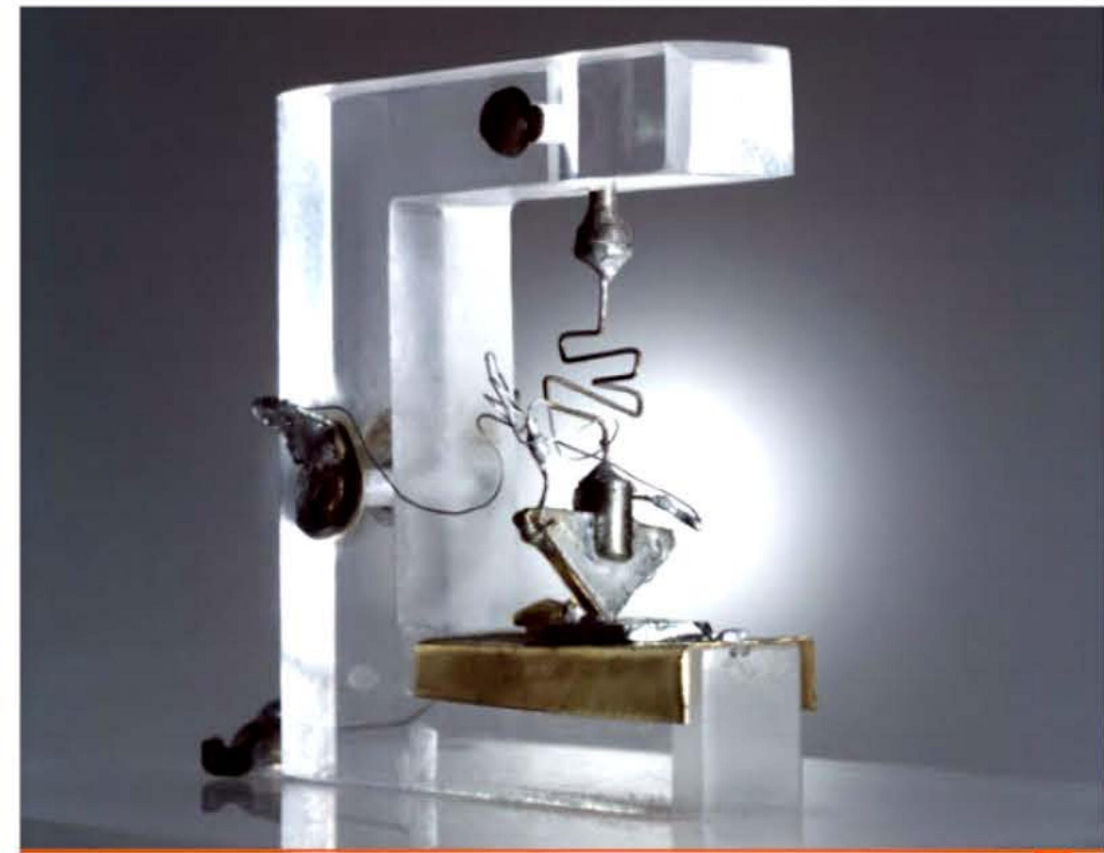
Le premier transistor, devenu objet d'exposition aux laboratoires Bell.
