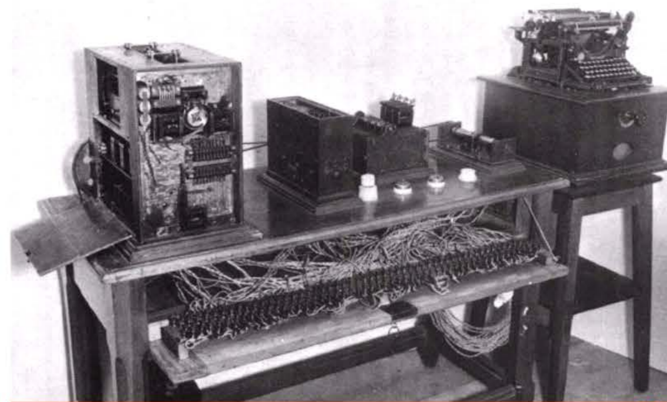
Machine analytique algébrique programmable de Torres-Quevedo, présentée à Paris en 1920.
