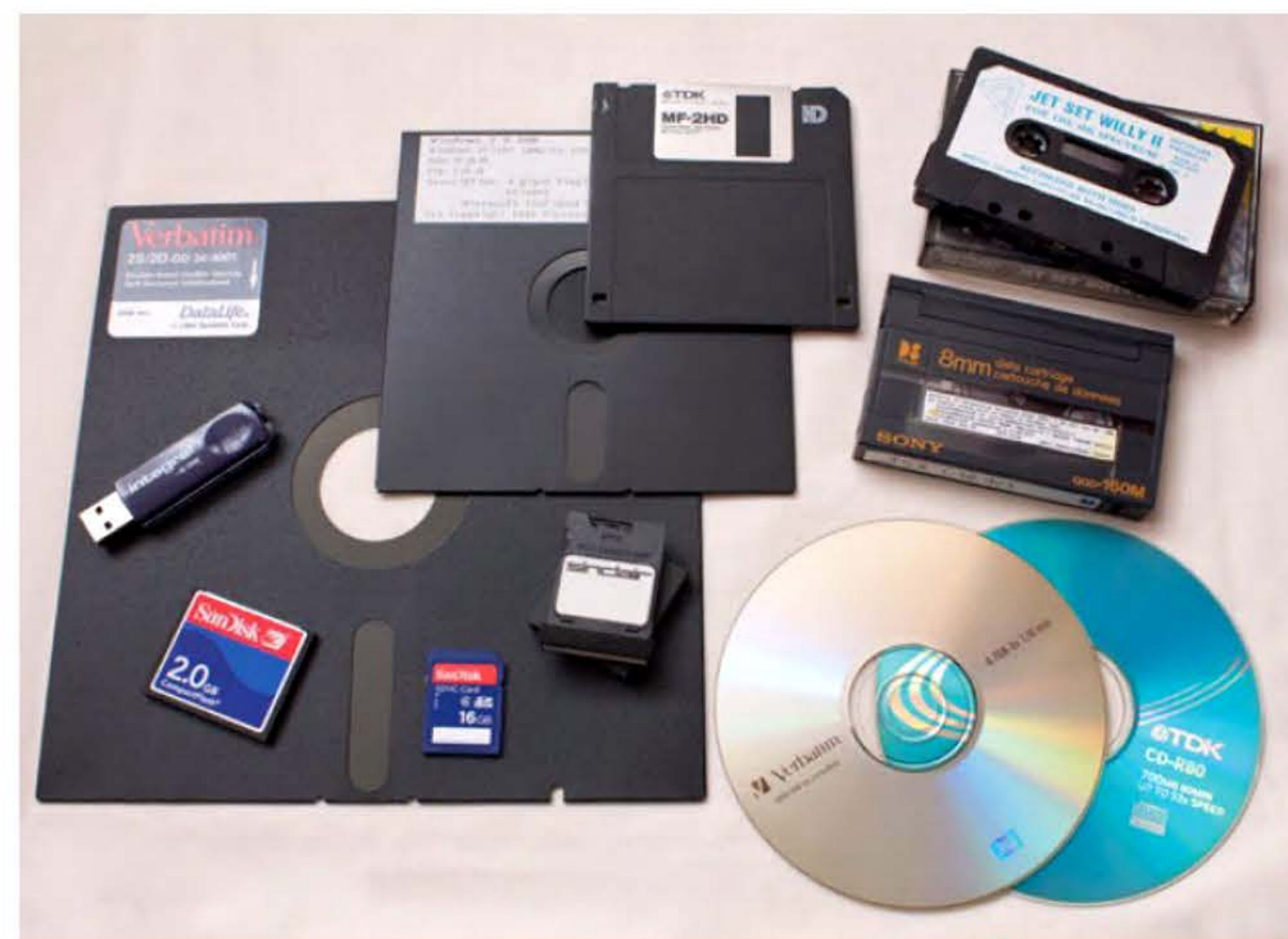
Supports de stockage amovibles : disquettes 3,5 pouces, 5,25 pouces et 8 pouces ; sur cette dernière, clé USB, cartes mémoires et cartouche microdrive (1984) ; en haut à droite une cassette audio, utilisée comme support de sauvegarde des premiers micro-ordinateurs, et une bande magnétique ; en dessous, DVD et CD-R.
