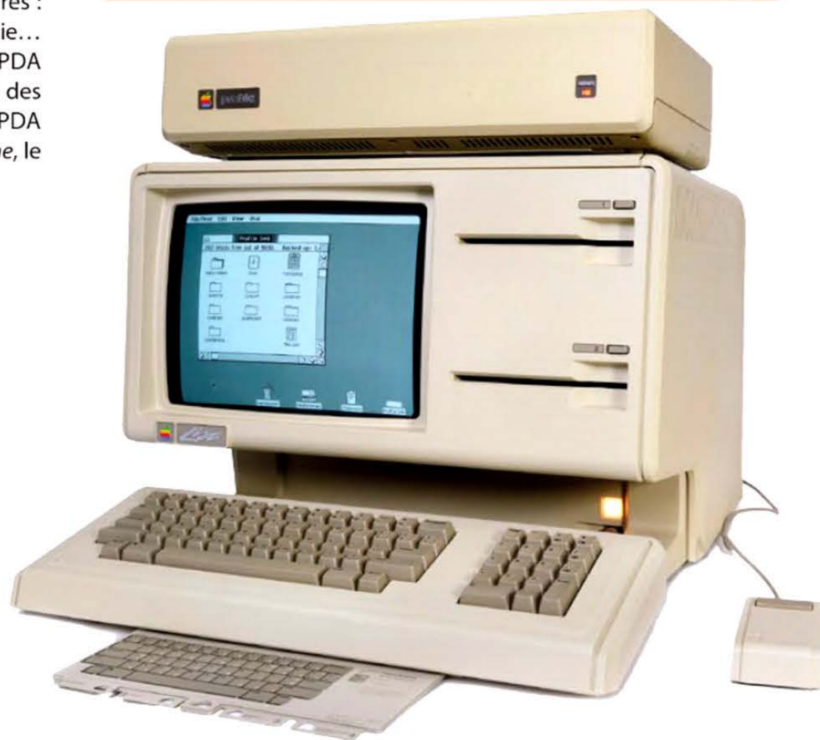
Le Lisa 1 avec son disque dur au-dessus de l'unité centrale.
