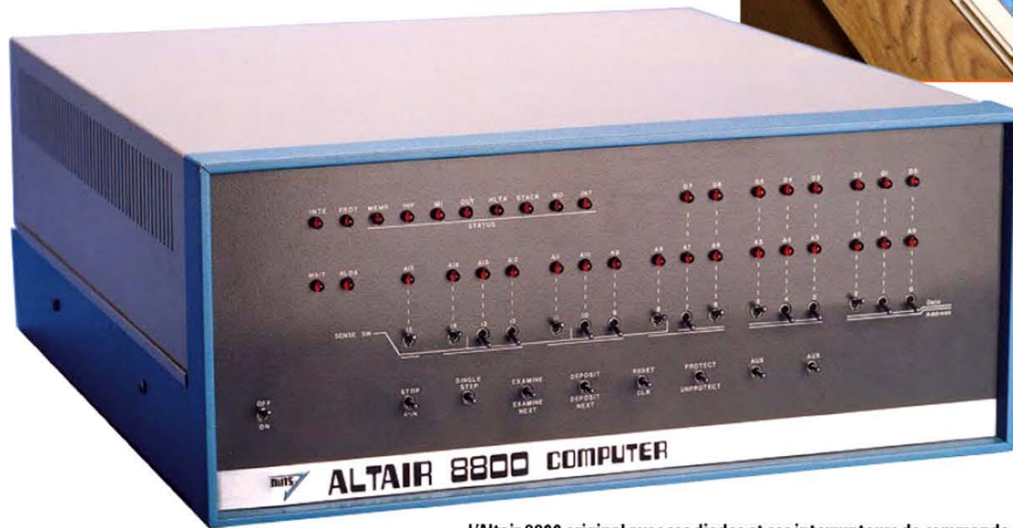
L'Altair 8800 original avec ses diodes et ses interrupteurs de commande.
