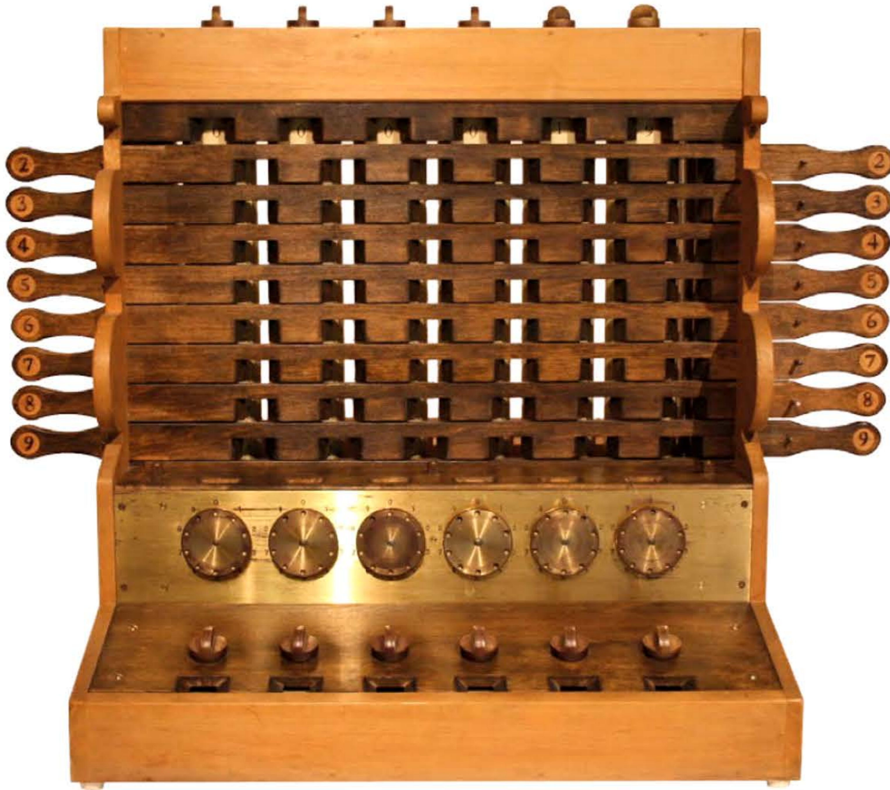
Réplique moderne de la machine de Schickard faite à partir des dessins laissés dans ses lettres à Kepler. Toute la partie supérieure de la machine correspond aux bâtonnets de Neper.
