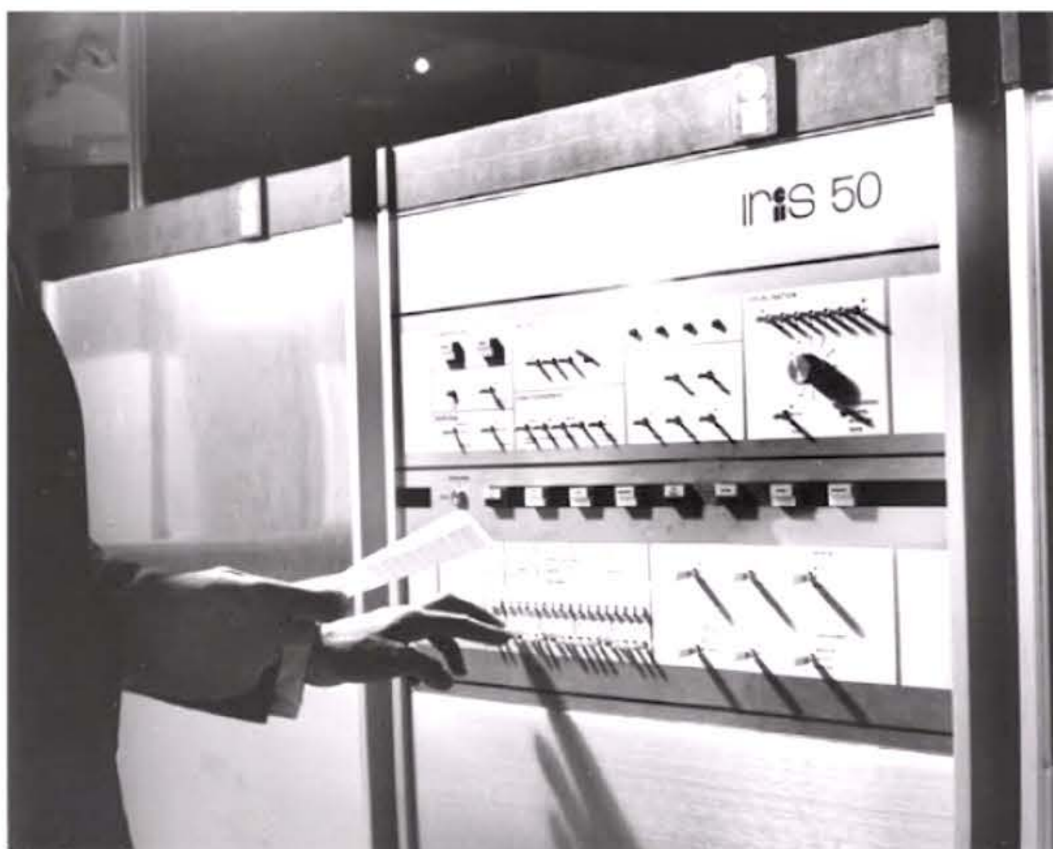
La programmation se fait encore parfois « aux clés », octet par octet (ici sur CII Iris 50, vers 1968).
