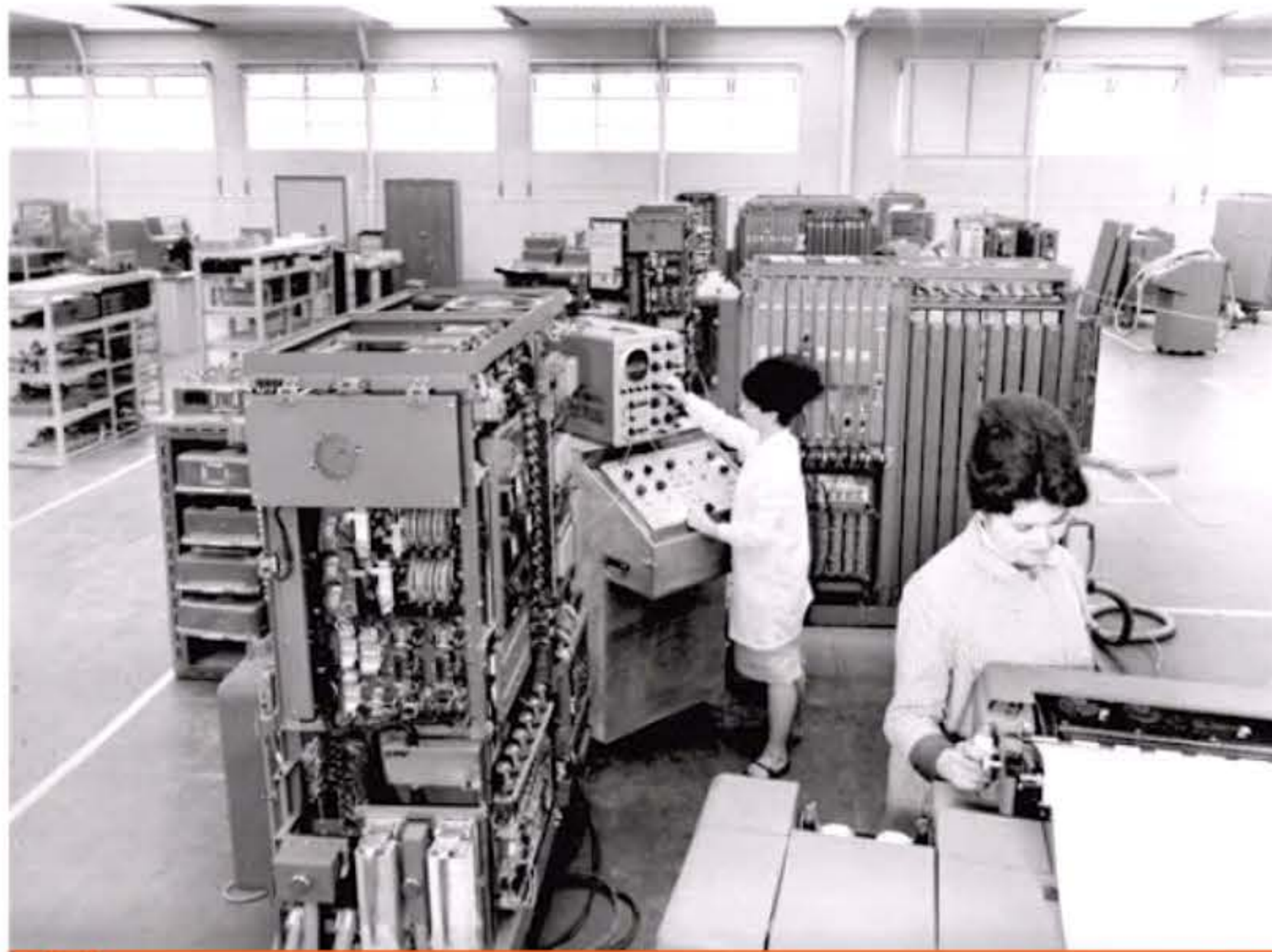
Montage et contrôle d'un Gamma 3 dans l'usine Bull à Paris.
